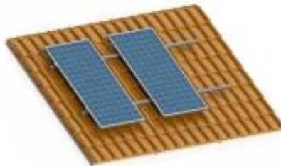
Positioneer het tweede paneel.
