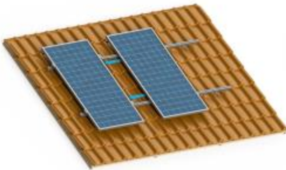
Schuif het paneel op zijn plaats en draai de tussenklem tot het aangrijppingspunt vast.
