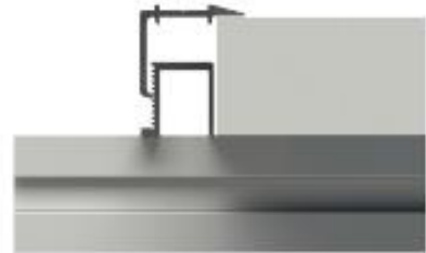
Zorg dat de onderkant van de eindklem op het montageprofiel rust.
