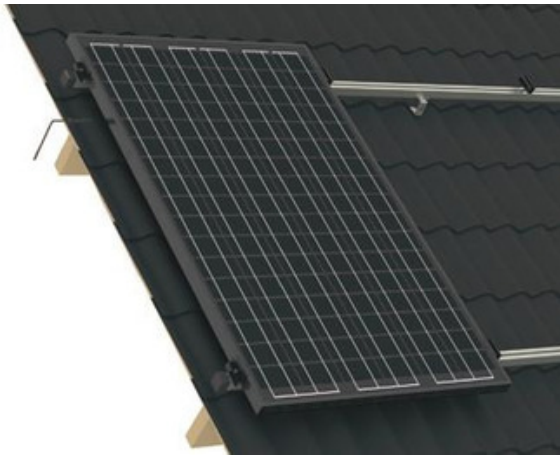
Bevestiging van zonnepanelen op een schuin dak
