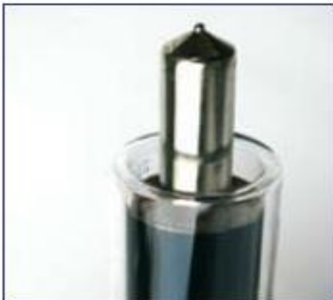
11.) Condensator (zilveren kop) voorzichtig ca. 10 - 15 cm uit de buis trekken.
