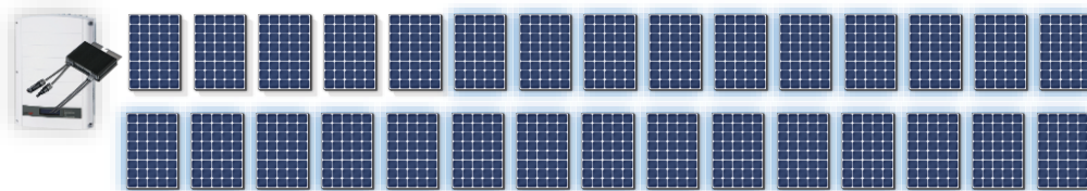
Figuur 8: Voorbeeld van stringlengtevergelijking van een stringomvormer vs. SolarEdge omvormer
