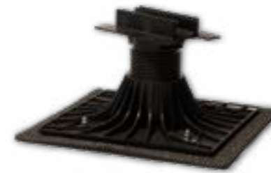
Soprasolar® Fix Evo 10 bevestigingsvoet Polyamide voet met verstelbare hoogte (120-160 mm) bevestigd op een SEBS-stuk van bitumen dakmembraan (250 g/m 2 ).
