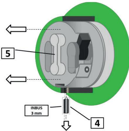
5. Drehen Sie die Inbus Schraube mit einem 3mm Inbus los.
