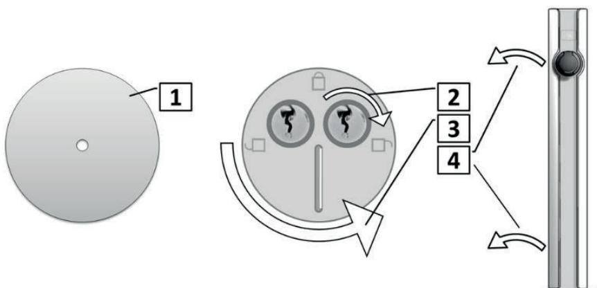
1. Entfernen Sie die Abdeckung, die das Schloss frei von Sand und Schmutz halten
