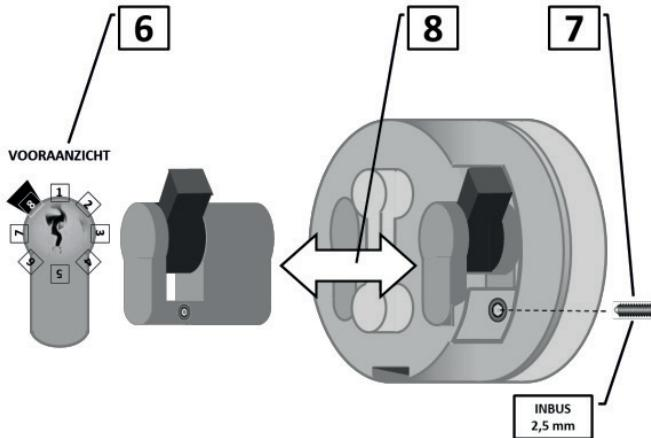
7. Drehen Sie den Schlüssel vom Zylinderschloss solange bis die Nocke wie in der Abbildung Nummer 6 steht.
