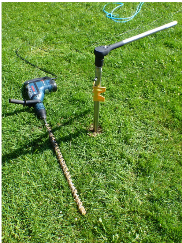
SDS-Max boormachine met betonboor ø40mm en een ratel met M20 dop op een M20 indraai adapter
