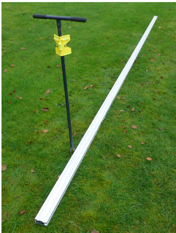
Grondboor (handmatig) Ø40mm met 3D waterpas en uitlijnprofiel
