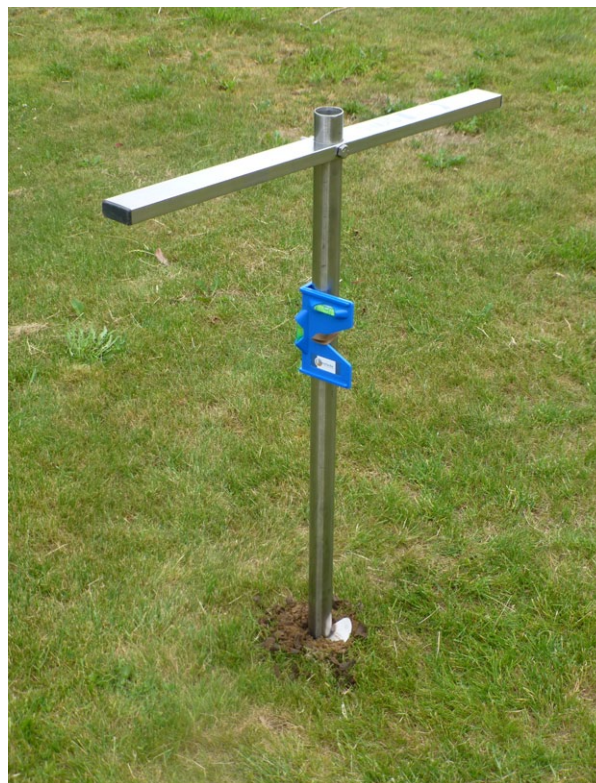
Handmatige indraaisleutel met 3D waterpas
