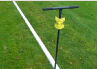
Palenboor Ø40 mm, om de gaten ±600 mm voor te boren
