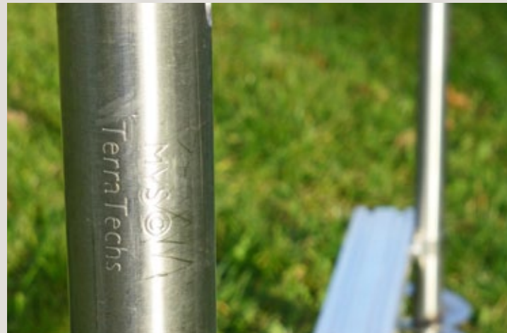
Palenboor Ø40 mm, om de gaten ±600 mm voor te boren
